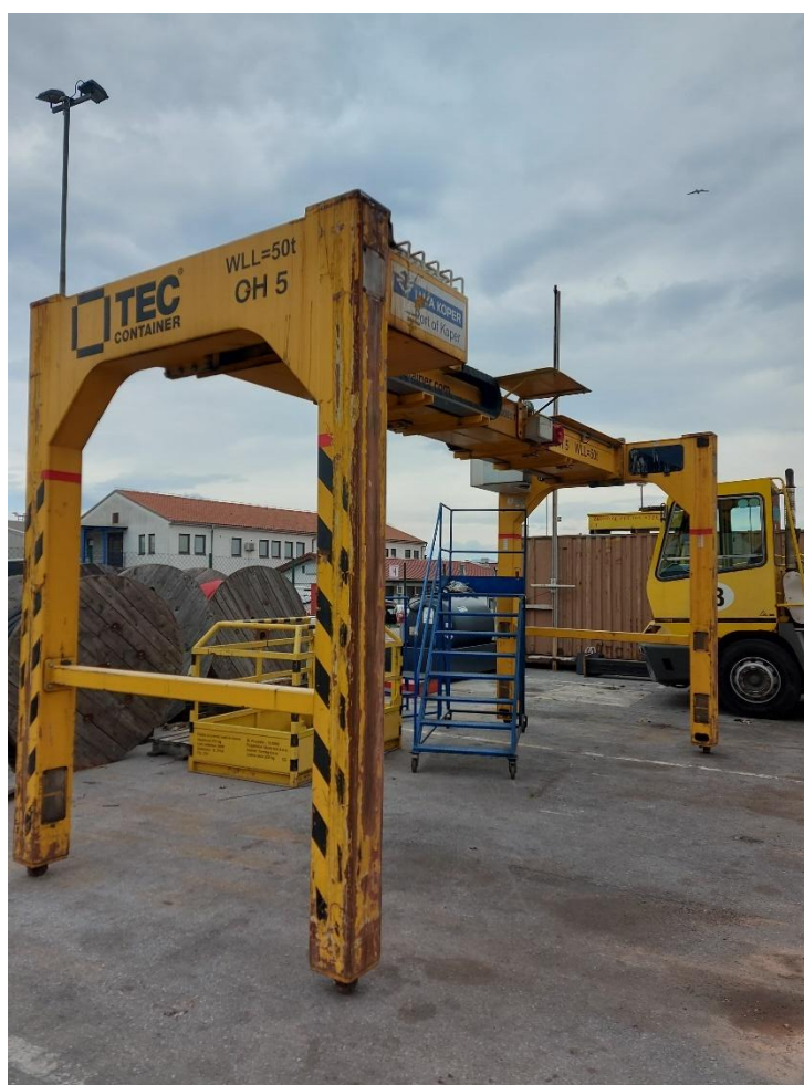
Slika 1: Prijemalo za izven gabaritne tovore (OH prijemalo)
